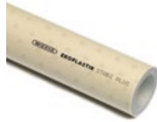
Труба Ekoplastik Stabi Plus Д 16-63 мм S 3,2 / SDR 7,4 / PN 28 (расчет) Д 75-110 мм S 4 / SDR 9 / PN 22 (расчет)
