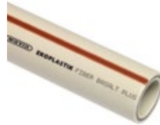
Труба Ekoplastik Fiber Basalt Plus Д 20-63 мм S 3,2 / SDR 7,4 / PN 28 (расчет) Д 75-125 мм S 4 / SDR 9 / PN 22 (расчет)
