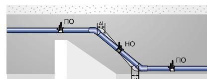
Пример за компенсиране чрез промяна на трасето заради строителната конструкция
