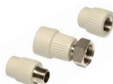
За затягането на резбовите връзки при малките размери се използва лентов ключ. При големите размери (от Ø 40 mm нагоре) с осмостен на резбата и за преходите с холендркова гайка се използва гаечен ключ.
