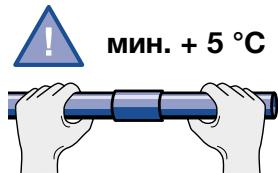
Минималната околнна температура за монтиране на пластмасови тръби, имайки предвид заваряването, е  $+5^{\circ}\text{C}$ . При по-ниски температури трудно се осигуряват условия за качествена заварка.
