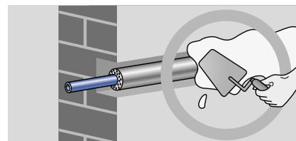
трасето на тръбите, да се реши компенсацията на линейното разширение в участъците, които са закрити, и тръбите да се изолират с качествена изолация (ако тръбопроводът е за студена вода, монтиран открито по стената в отоплявано помещение, съществува голяма опасност от образуване на конденз). Тръбопроводът може да бъде монтиран открито по стена само там, където няма опасност от механично увреждане на тръбите в резултат на работата в помещението.
