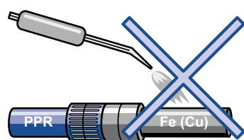
При заваряването трябва да се спазва точно установения ред и да се използват подходящи инструменти. Не се позволява свързване на елементи от системата Ekoplastik PPR с елементи на друг производител.
