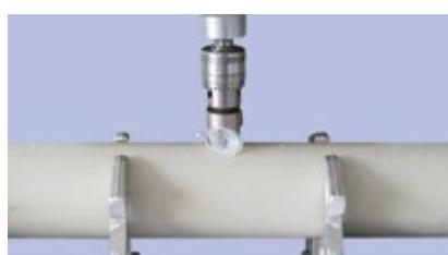
① Пробиваме отвор в тръбата със специалния свредел.
