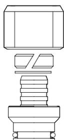
Соединитель для трубы PE-RT/Al/PE-RT
